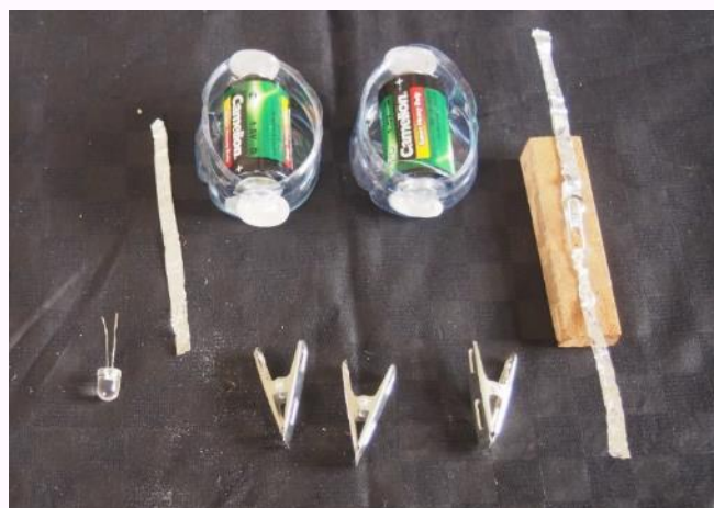
手作りの電池ボックスと導線
