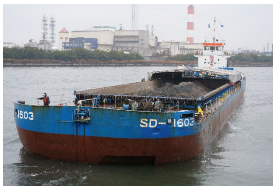
写真 2-10 廃棄物の輸送船 (飛散を防ぐため出港後に屋根が閉まる)
