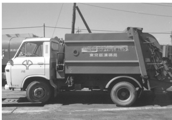
写真 2-6 圧縮機能を持つ収集車両（パッカー車）
