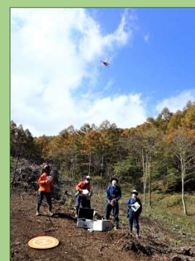
ドローンによる検査。実証例によると現場作業に要する時間は従来の1/4程度とのこと
