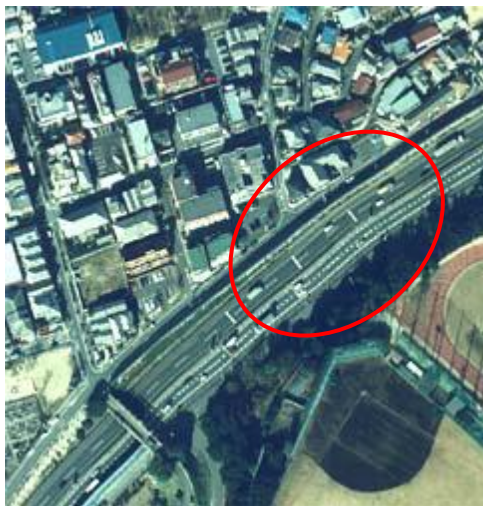
道路の局所歪み（空中写真の例）
