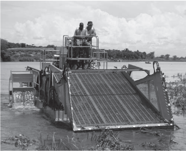
導入・普及を目指す「水草除去船WH(ウィードハンター)-3000モデル」。手作業の数十倍以上と言われる作業効率性、操作性の高さ、耐久性などに特徴がある
