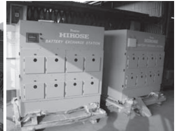
バッテリー交換ステーション
