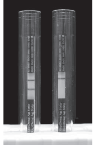
検体(血清、全血など)および展開液に本製品を挿入、10~20分で出現するラインの本数で陽性・陰性を判定する
