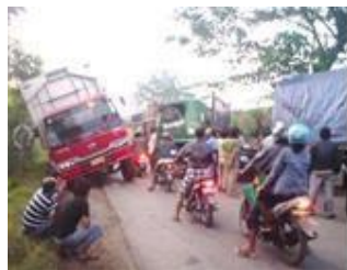
オーバーレイ工法により脱輪した車
