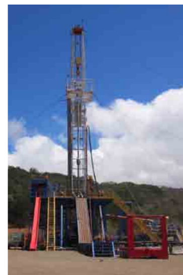
ラス・バイラス2の掘削現場。地下深部から熱水や蒸気を取り出し、発電のエネルギー源として使う。
