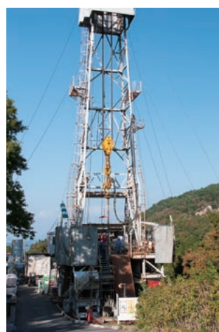
鉄塔につり下げられた掘削機で蒸気を取り出すための井戸を掘る
