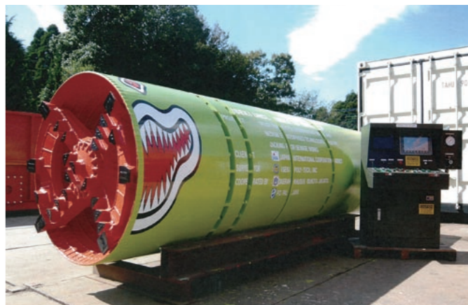
先端に回転するカッターが付いた掘進機と遠隔操作パネル。地中を進んでトンネルを掘っていく
