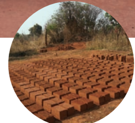
移住者手作りのレンガ。干して固まったら自ら積み上げ、住居とする
