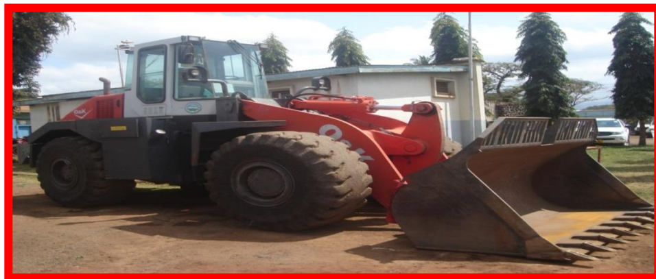
Mtambo maalumu wa kusukuma na kusambaza taka (wheel Loader) katika Dampo la kisasa
