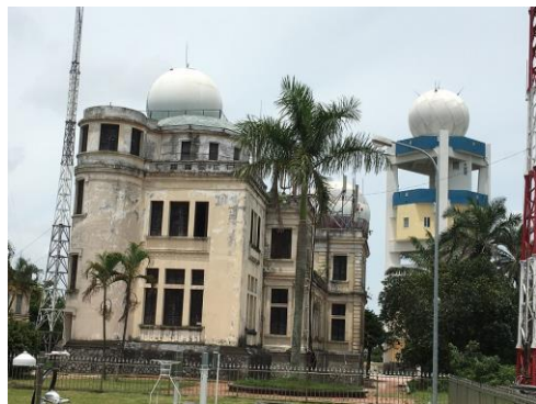
ハイフォンの近郊に設置された日本製の最新レーダー（右端）。左側の建物屋上には、一世代前のフランス製レーダーや二世代前のロシア製レーダーのドームが残っている。
