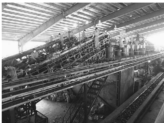
写真-1 収集した混合ごみのMBT/手選別プラント (テヘラン・2013年11月)。資源ごみを選別した後、生分解性成分はコンポスト化され、残渣は焼却 (予定) される。
