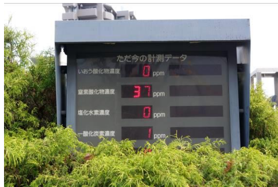
写真 4-53 排ガスの濃度が施設で公開されている様子 (渋谷清掃工場)
