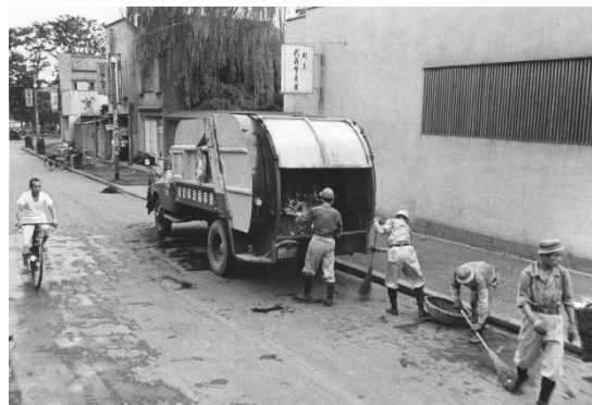
写真 4-4 パッカー車による収集作業の機械化の試験的導入の様子（1957年頃）
