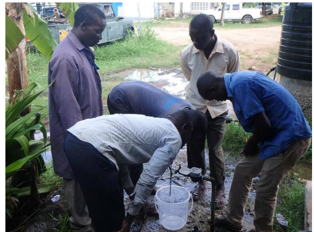
メモリ付きバケツを利用したメータ精度の確認
