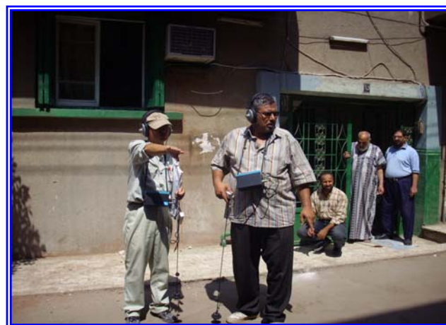
写真 2 漏水探査活動の実施
