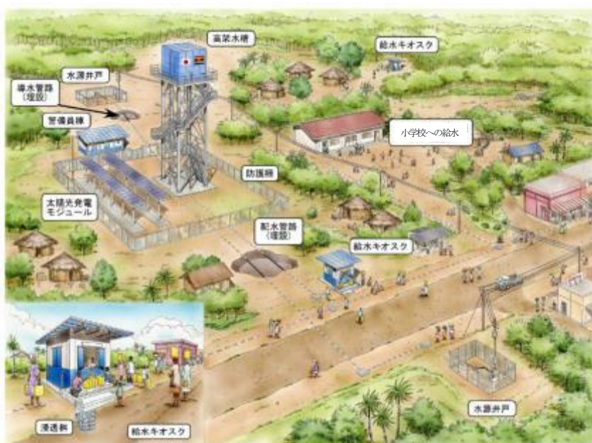
図 4：管路給水施設（レベル 2）の例（図 1 再掲）
