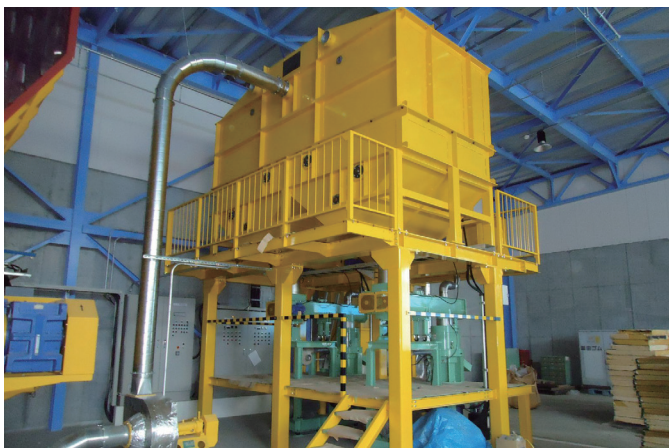
廃プラスチックから固形燃料をつくりだすRPF製造機
