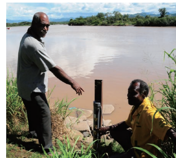
危険水位になるとサイレンが鳴る水位計を各地域に設置
