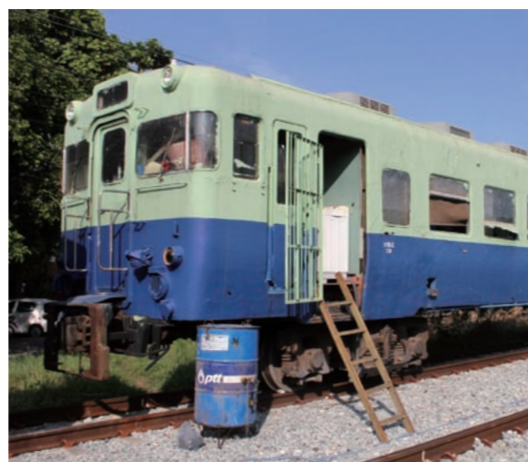
ディーゼル車両の国鉄キハ58系。非電化の路線には、こうしたディーゼルエンジンで走る気動車が欠かせない(撮影:白川淳)
