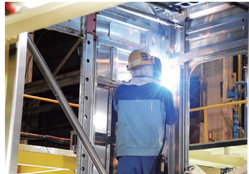
車体の溶接作業の様子。車体の大きさに毎回多くの研修員が驚くという
