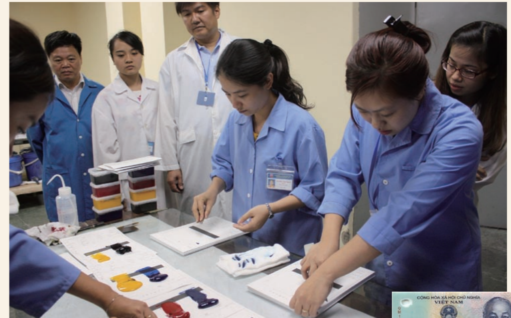
インキの調色実験。日本人短期専門家(白衣の男性)の指導の下、工場職員たちは調合したインキの色相を熱心に確認している。
