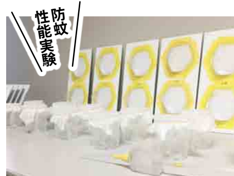
防蚊塗料を塗装したパネルに円錐形のカップを貼って蚊を中に閉じ込めるコーンテスト。蚊を塗面に強制接触させたのち、24~96時間後の蚊の致死率を調べる。
