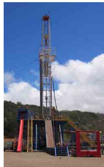
ラス・バイラス2の掘削現場。地下深部から熱水や蒸気を取り出し、発電のエネルギー源として使う。
