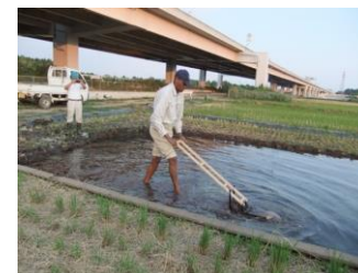
ショーさんが本邦研修で試作した回転式除草機と性能試験風景
