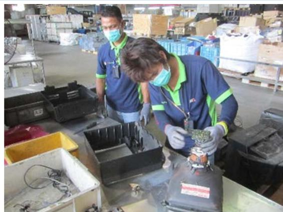
写真3. ブラウン管テレビの解体テストの実施状況（マレーシアにおける E-waste 管理制度構築支援プロジェクト）
