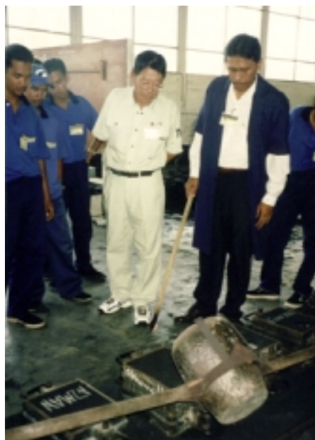
ブミプトラの職業訓練校で、砂型鑄造の実習を指導するシニア海外ボランティア(中央)
