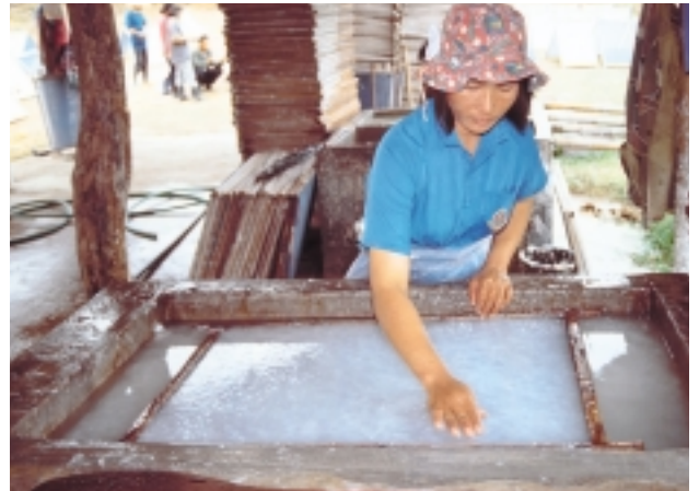
小規模パルプ工場での紙濃きの様子
