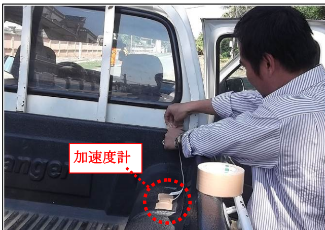
図3: DRIMS 設置状況
