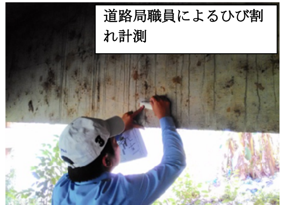
図.1 道路局職員に対する JICA 専門家による橋梁の点検の指導
