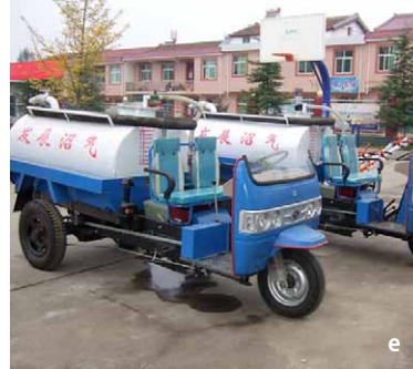
a. 草バ村で栽培されている在来種のナシ / b. 栽培管理研修会(集中型研修) / c. 黄金梨 / d. 粘着シートや誘引灯による害虫防除法の現場研修(継続型研修) / e. メタンガス汚泥吸取り用の小型バキュームカー / f. 有機認証マークとトキブランドが入った黄金梨のパッケージ
