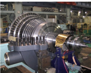
蒸気の圧力や量などラヘンドン地域の地熱資源の特性に合わせて設計されたタービン。日本の技術の結晶だ
