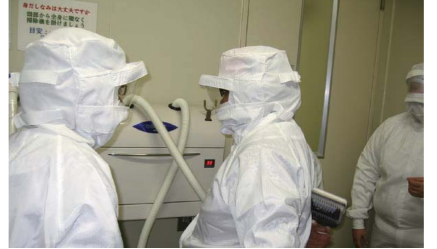
和漢薬の製造現場では安全衛生管理が必要不可欠。防じん服に着替え、表面に付いている汚れは掃除機で除去する
