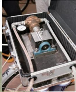
ペダルをこいで水をくみ上げ、後部車輪に装着したフィルターを通して浄化。八千代エンジニアリングの杉田昌也さん(左から2人目)は、「勝浦さんのような決断の早さが途上国でのビジネスでは重要」と話す
