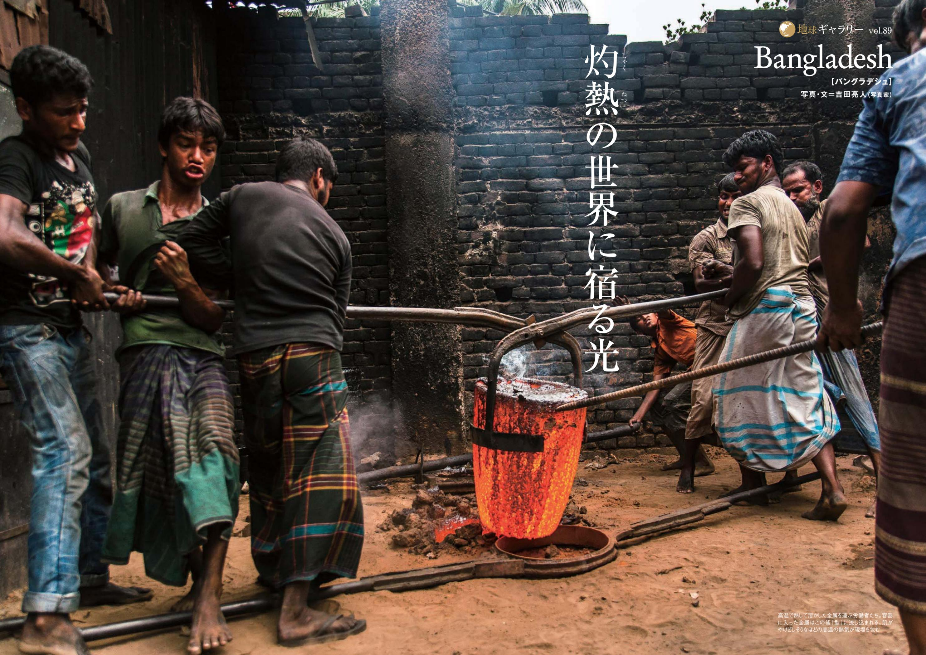
高温で熱して溶かした金属を運ぶ労働者たち。容器に入った金属はこの後「型」に流し込まれる。肌がやけどしそうなほどの高温の熱気が現場を包む
