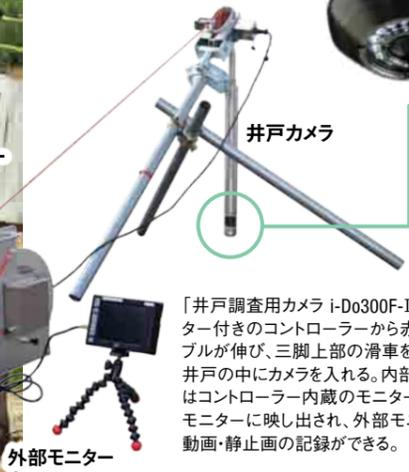
「井戸調査用カメラ i-Do300F-II」。モニター付きのコントローラーから赤いケーブルが伸び、三脚上部の滑車を介して、井戸の中にカメラを入れる。内部の様子はコントローラー内蔵のモニターと外部モニターに映し出され、外部モニターで動画・静止画の記録ができる。
