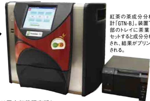
紅茶の茶成分分析計「GTN-B」。装置下部のトレイに茶葉をセットすると成分分析され、結果がプリントされる。
