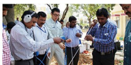
Transferência de tecnologia de detecção de vazamento de água para funcionários do Departamento de Saneamento Básico de Bengalaru (foto fornecida por: Saitō Technical Service Co., Ltd.) Projeto de extensão e demonstração do sistema de detecção de vazamento de água usando detector automático de sons de vazamento de água.
