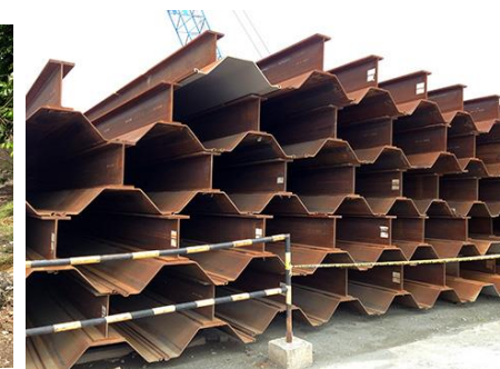
(写真左) 改修を行うマリマンゴ排水路 (写真右) 本事業で活用予定のハット形鋼矢板及びH形鋼（本邦技術）
