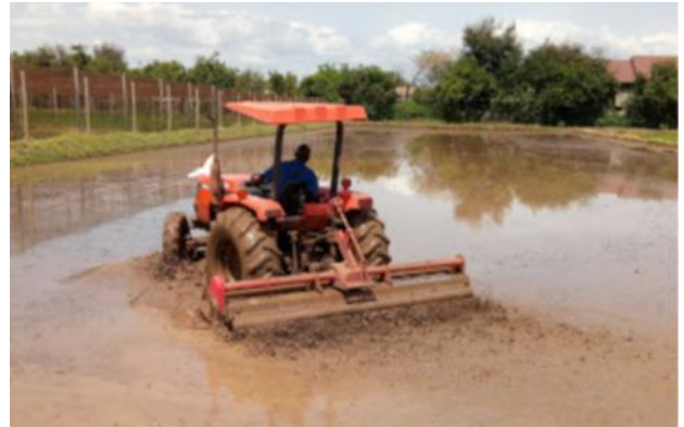
ニプロの Drive Harrow で広い水田圃場も効率的に代掻き・均平されることが期待されます
