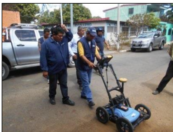
写真10 地中レーダー探査の実習
