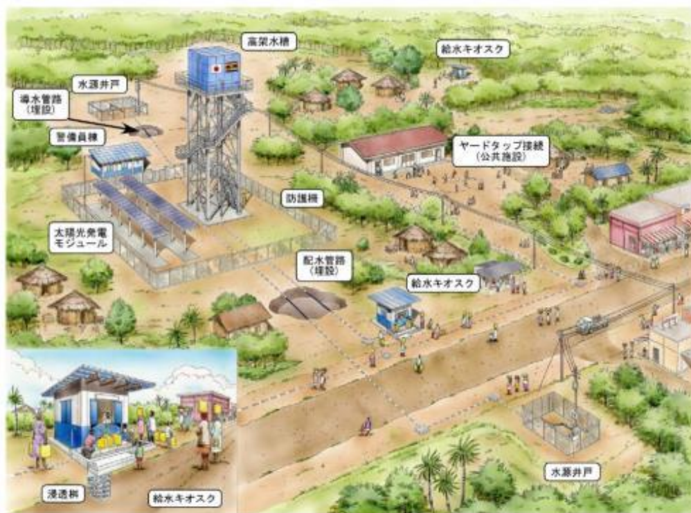
図1：管路給水施設のイメージ
