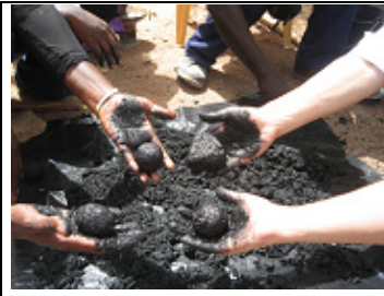
modelage de boulettes de charbon
