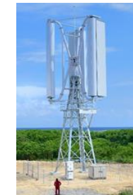
10kW垂直軸型マグナス型風力発電機
