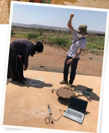
牧畜民が使用する井戸の水位や塩分濃度などを計測し、季節の変動を調べ、牧畜や農業に、また生活用の水として利用できる可能性を調べている。(JICA/JST SATREPSプロジェクト/東京農業大学 島田沢彦)
