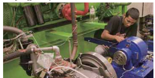
Ujicoba keterbakaran dan kecepatan pembakaran biodiesel di ITB (Proyek SEED-net)
