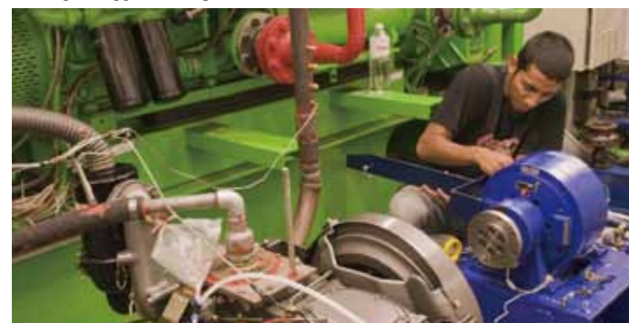
Uji coba keterbakaran dan kecepatan pembakaran biodiesel di ITB (Proyek SEED-net)
