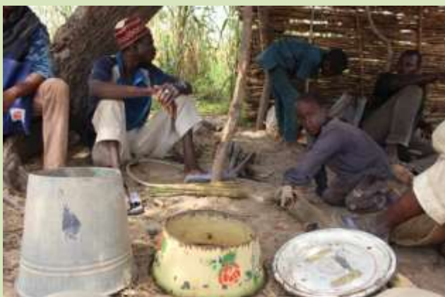
農村の金属リサイクル・センター：鍛冶屋が生活用具や農具をつくっています。底が抜けたバケツをファンテーカ(中央)とふた(右)で、底をふさぎます。
