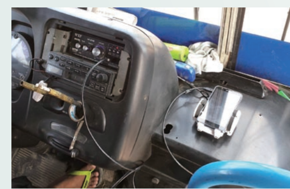
バスの運転席に搭載されたスマートフォンを使い、数秒間隔で位置データや車速データなどを取る。データは自動でサーバーに送られる仕組みだ
