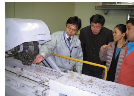
北海道の研修で寒地土木研究所を訪れたウランバートル市役所の職員たち。車の冬用タイヤチェーンでアスファルトがどうすり減るかを調べる装置に興味津々
