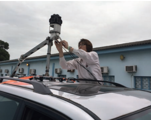
モバイルマッピングシステムを道路公社の車に設置する関口さん。現地道路公社が自前の機材を持ち、使いこなすことは、道路整備を外国に頼らずに済むということでもある
