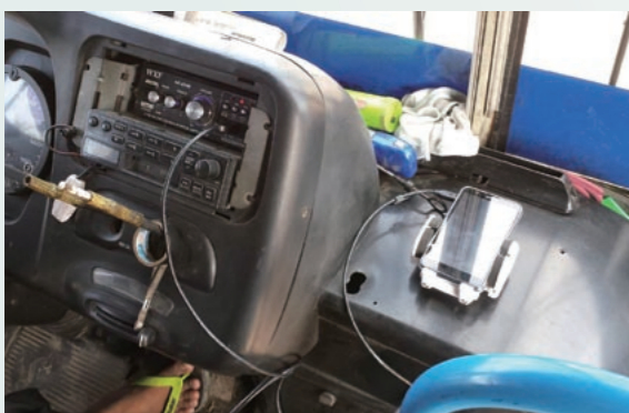
バスの運転席に搭載されたスマートフォンを使い、数秒間隔で位置データや車速データなどを取る。データは自動でサーバーに送られる仕組みだ
