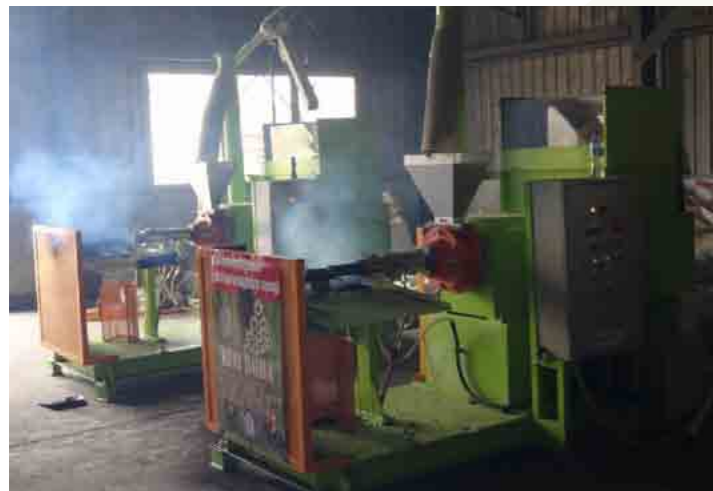
タンザニアで行った普及・実証事業での機械「グラインドミル」でモミガライトを製造する様子 (写真すべて:トロムソ提供)
